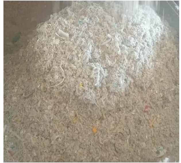
Resim 9. 150 Derecede Sterilize Edilmiş Tıbbi Atığın Son Hali
