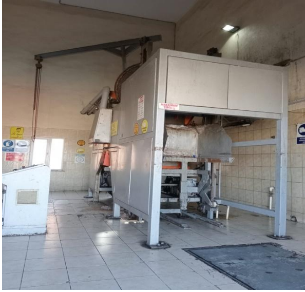
Resim 17. Tıbbi Atık Sterilizasyon Ünitesi
